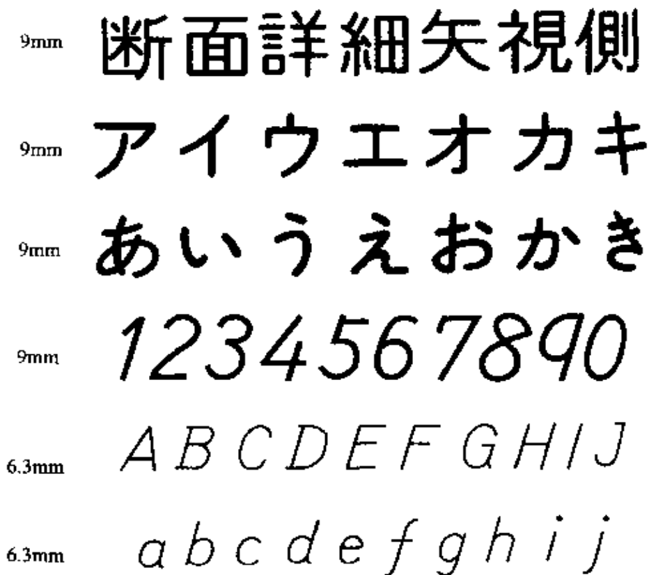
图 5.55 制图用文字示例(J形斜体)
