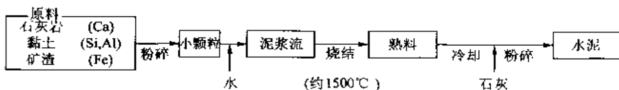
图 4.40 水泥制造工程
