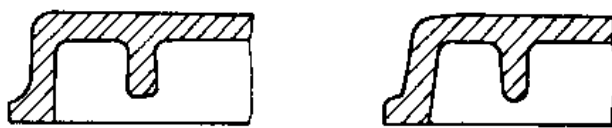
(a)改进前 (b)改进后 图 6-15 起模方向留有结构斜度
