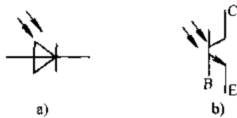
图 12.4-4 光电二极管、光电三极管图形符号
