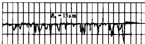
图 4-10 平顶珩磨表面的微观轮廓曲线
