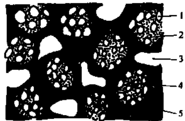
图 3-7 细粒度磨料的大颗粒磨粒砂轮结构
