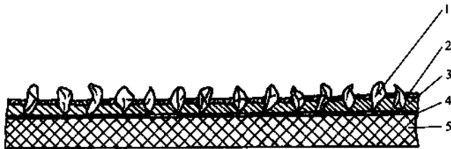
图 3-4 涂覆磨具结构示意图
