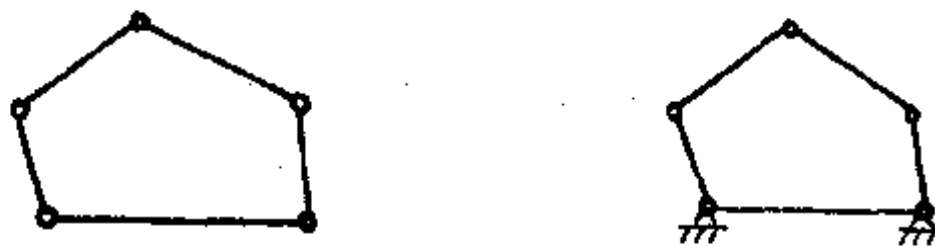
图 1-9 n=5 的运动链和机构
