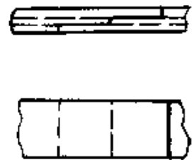
图 7-90 橡胶传 动带的胶合接头
