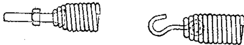
图 4-3 端部加工和装配件并用的例子
