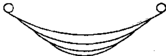
图 6-31 板弹簧的密合度
