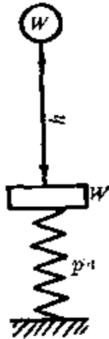
图 1-6 由弹簧支持的物体 与自由落体 W 的冲撞
