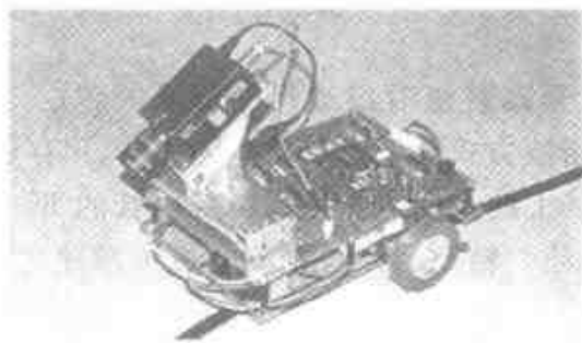
图 10.16 用 CCD 摄像机导向 (左右步进电机驱动行走)
