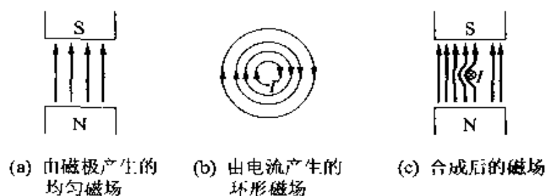
图 2.46 导体上产生磁力的原因
