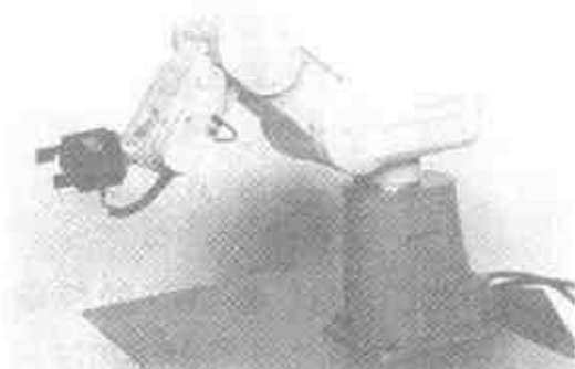
图 8.6 5 自由度垂直多关节机器人“RV-M2”
