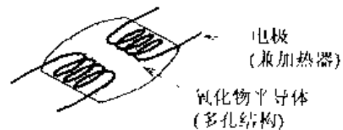
图 4.65 半导体气敏传感器的结构示例
