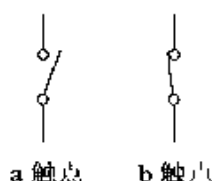
图 7.25 保持型开关的图形符号
