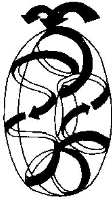
图 10-4 涡轮转动时的油液螺旋形路线
