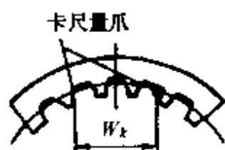
图 6-12 内齿轮公法线的测量
