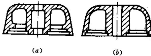
图 12-2 孔洞设计 (a) 不合理 (b) 合理
