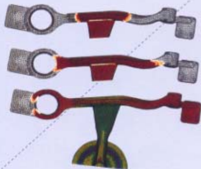
铝合金触变铸造中充型过程的连续视图
