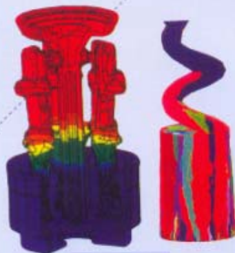
可以分析发生在晶粒选择器中复杂的冶金学过程，以便优化单晶镍基涡轮叶片的熔模铸造
