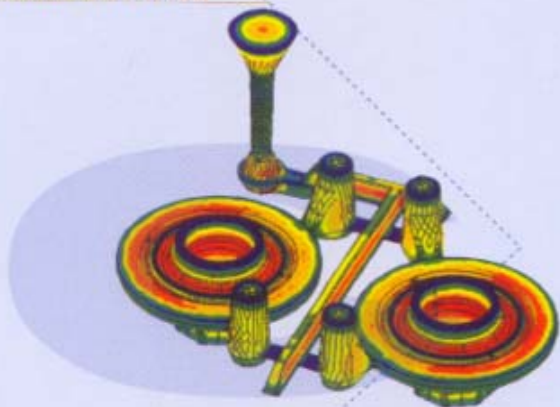
砂型球墨铸铁件中珠光体的分布（较暗的区域表示珠光体较少）
