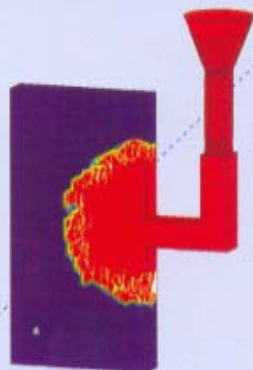
消失模铸造的模拟。这些结果清楚地显示出消失模（紫色）对液态铝（红色）充型过程流动的影响
