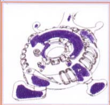
高级的X射线分析功能有助于识别封闭的金属液穴，精确地定位产生缩孔缩松的部位
