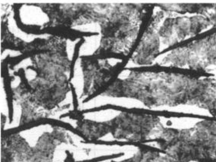
(b) 铁素体 + 珠光体灰铸铁
