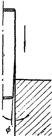
图 18-5 压装零件的倾斜角示意图
