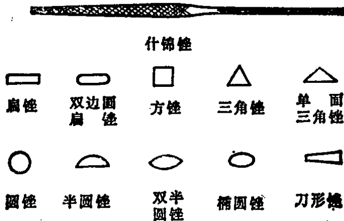
图 10-2 什锦锉的断面形状
