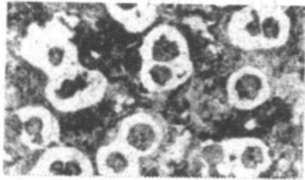
(a) F + P 基体 + 球状石墨 ( \times 100 ) (b) F + P 基体 + 球状石墨 ( \times 500 )
