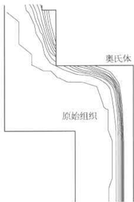
图 14 差温加热结束时工件内组织分布模拟结果
