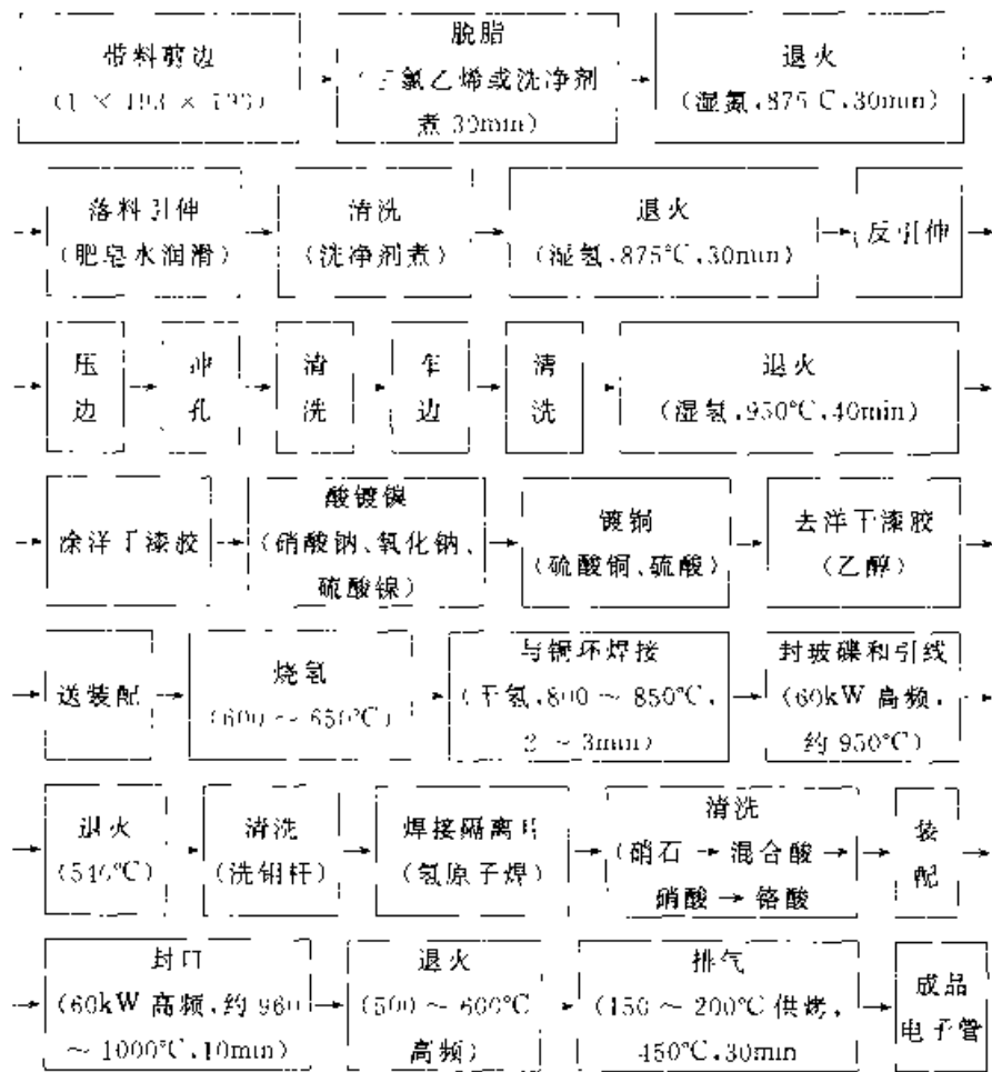
图 10-71 用 4J29 合金制造 Fu-23Z 电子管的生产流程和热处理制度
