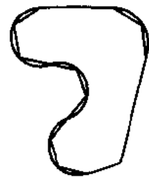
图 8-6 零件图形的多边形化
