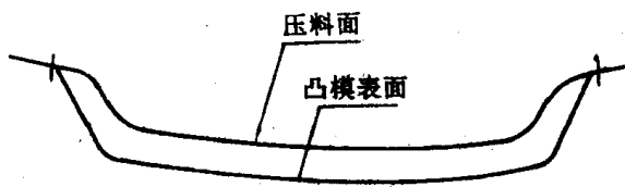
图 1-7 压料面展开长度比凸模表面展开长度短的示意图
