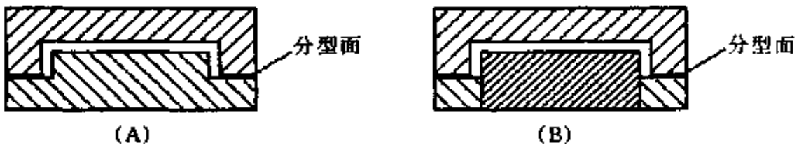
图 6-5 模芯凸出于分型面之上，凸出的模芯 (A) 以及镶嵌的模芯 (B)
