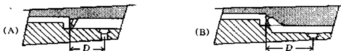
图 10-39 浅制品的隧道式浇口
