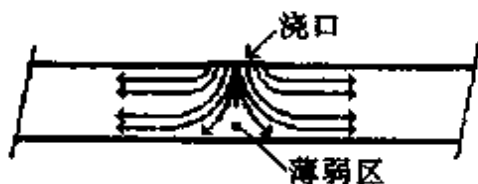
图 10-8 箭头方向表示塑料料流在浇口处的分流以及在浇口处形成的薄弱区
