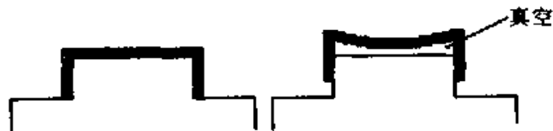
图 12-8 帽形制品从模芯上顶出时，顶部形成的真空会使制品变形
