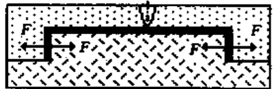
图 6-7 模腔中平衡的水平力 F
