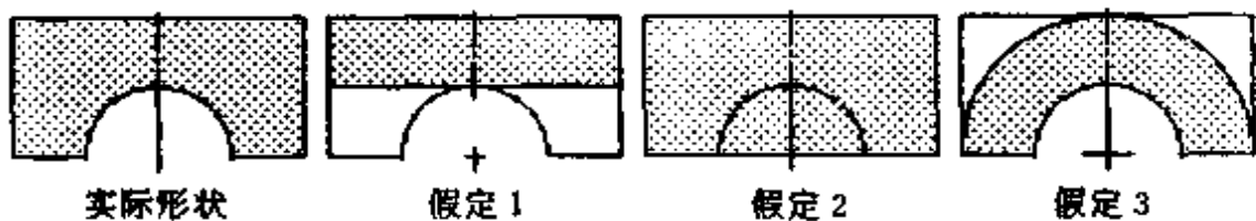
图 30-22 使用假定 1、2 和 3 计算实际形状的惯性矩
