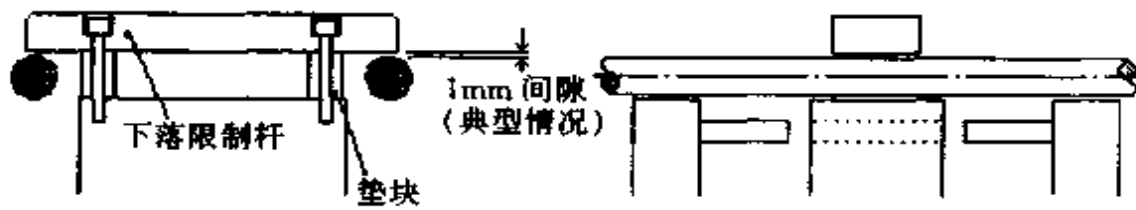
图 15-13 下落限制器安装在模板顶部防止中间部分从两拉杆间脱落
