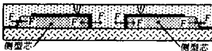
图 6-12 采用模楔的侧型芯获得力平衡
