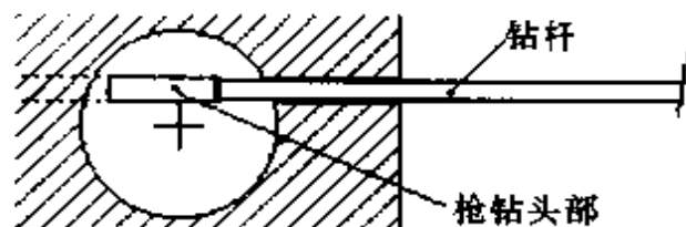
图 22-43 小钻头通过大孔失去导向
