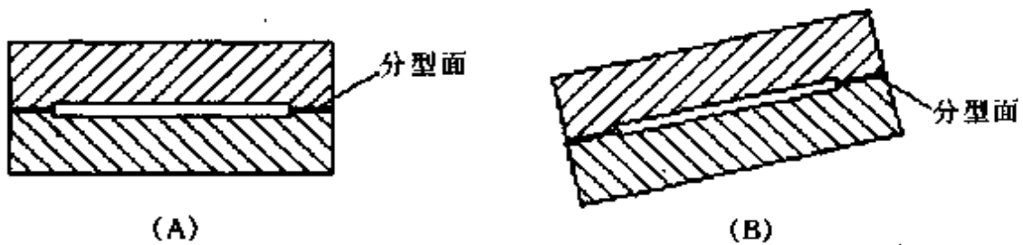
图 6-4 分型面最好位于同一平面内，无论是水平的 (A) 还是与模具方向成一角度 (B)
