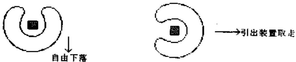
图 15-14 马蹄形制品：顶部开口允许自动脱落（左）开口在一侧，允许水平取出（右）
