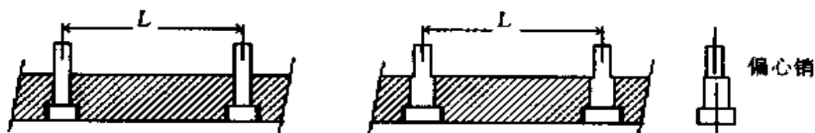
图 8-6 为了保证的孔间距，普通销子（左） 要换成偏心销（右）从而允许制品收缩
