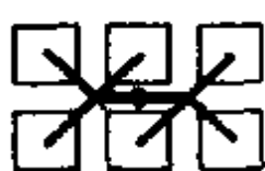
图 6-40 这种在三板式模具中常用的 6 腔设计方案称为“双 Y”设计方案
