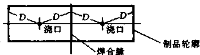
图 10-10 从浇口到连接处和到制品边缘的距离 D 应相等
