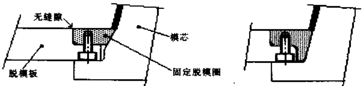
图 12-48 固定的脱模圈设计
