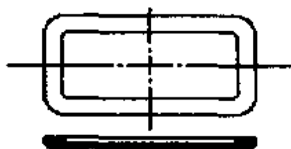
图 8-1 一个具有厚凸缘的平整制品，由于不均匀壁厚在顶出后可能会发生扭曲
