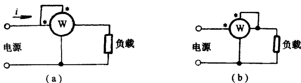
图 3-21 用功率表测量功率
