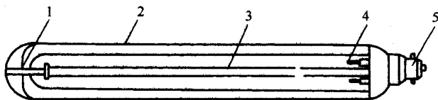
图 16-34 低压钠灯结构
