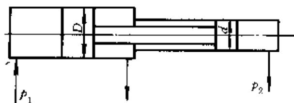
图 4-11 增压缸工作原理图
