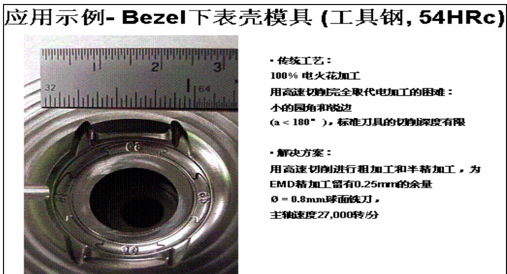
图 4 Bezel 电极加工
