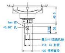
A部详图 (第3、4关节处于原点的姿态)
