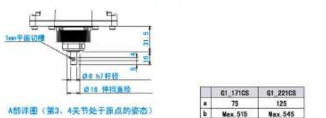
A部详图 (第3、4关节处于原点的姿态)
