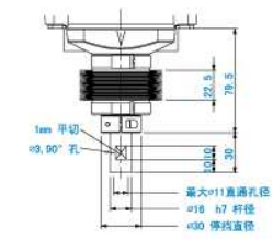
A部详图 (第3、4关节处于原点的姿态)
