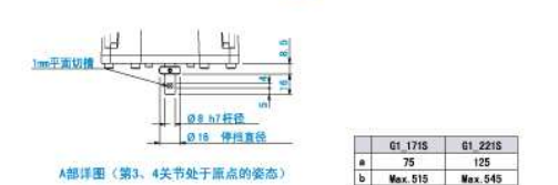
A部详图 (第3、4关节处于原点的姿态)
