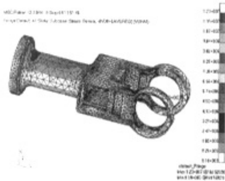
图 3-1 小臂冯式应力分布图 Fig.3-1 Distributing of von mises in the small arm
