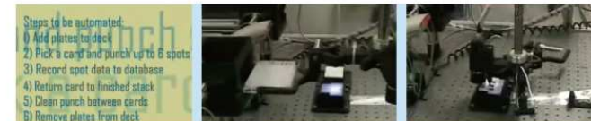
用一台机械手完成对血样试纸化验的全过程
