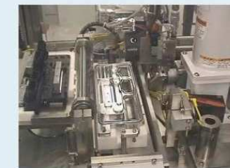
按轨迹进行涂胶作业，轨迹精度 0.1mm
