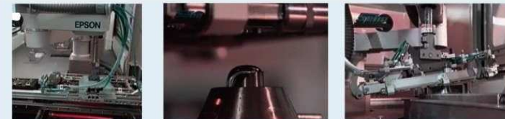
利用外部控制点(ECP)技术，进行部件周边的锡焊作业
