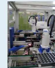
汽车用小零件的 Tray 盘码放
