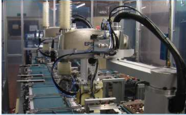
洁净型机器人进行巧克力的码放作业
