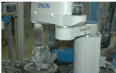
克服恶劣环境，用防尘型机器人进行工件打磨
