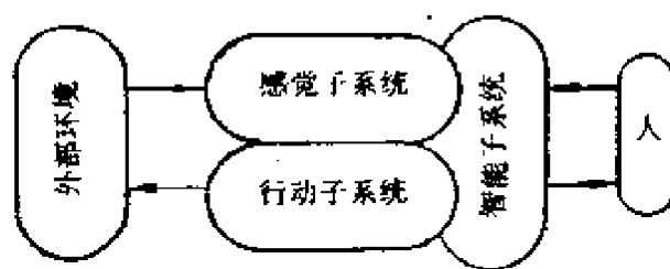
图 3-1 智能机器人的三个子系统
