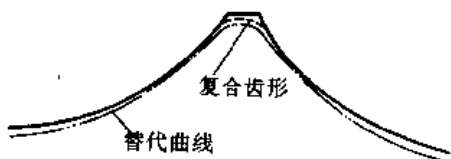
图 14.4-6 大传动比复合齿形与替代曲线
