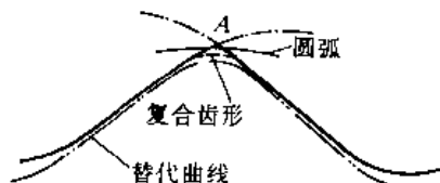
图 14.4-5 二齿差的齿顶曲线
