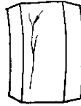
图8-10-13 外圈滚道疲劳裂纹
