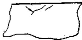
图8-10-1 金属表面下疲劳裂纹
