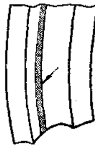
图8-10-8 角接触球轴承外圈滚道上的塑性变形
