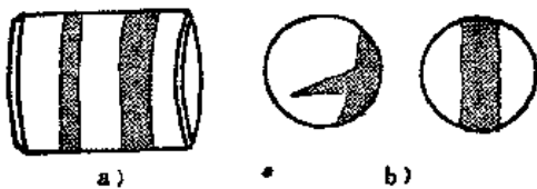
图8-10-5 滚动体滚动表面磨损 a) 滚子 b) 钢球
