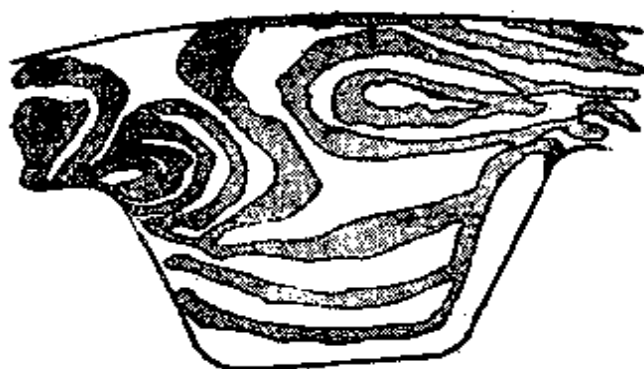
图8-4 梯形齿在纵向截面中的应力分布
