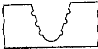
图5-1-3 铸铁冷焊坡口面上开槽示意图
