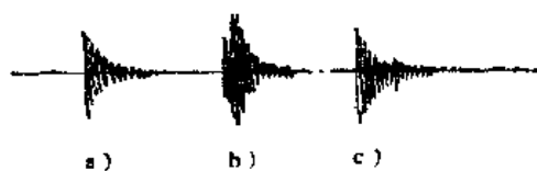
图8-9-10 振动机停车后振幅曲线
