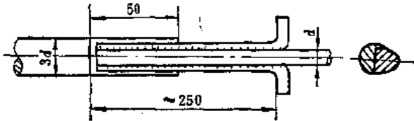
图23-5-12 低碳钢引出棒的搭焊
