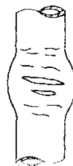
图 3-3-4 环向裂缝破裂
