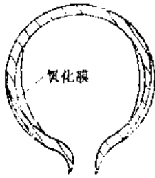
图3-3-5 管子局部过热氧化爆裂
