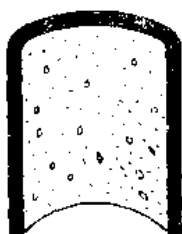
图 3-3-2 斑点深坑腐蚀
