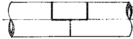
图23-4-10 硬铅管固定管口开洞焊接
