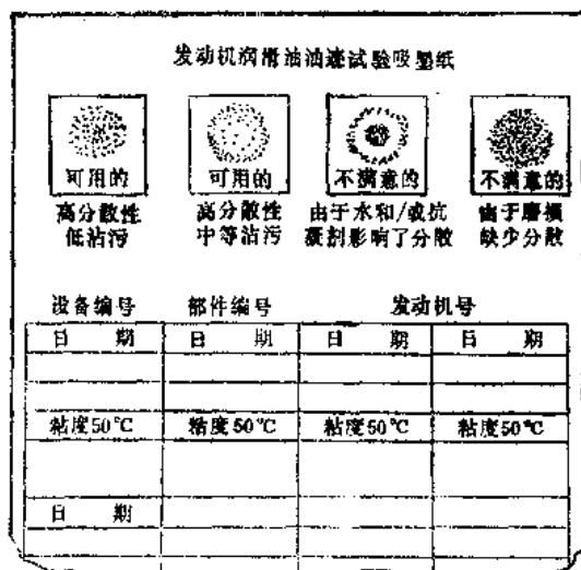
图6-1-15 机械杂质的吸墨显示法
