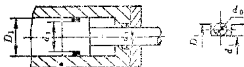
图10-2-3 O形圈压缩量示意图
